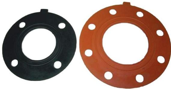
Les joints de brides K60 sont des joints élastomère percés. La surface du joint est moulée de manière à former deux surépaisseurs. Grâce au profil percé, le joint est toujours parfaitement centré. Les surépaisseurs de la surface du joint permettent une meilleure résistance à la pression à couple de serrage équivalent, ce qui augmente l'étanchéité.
